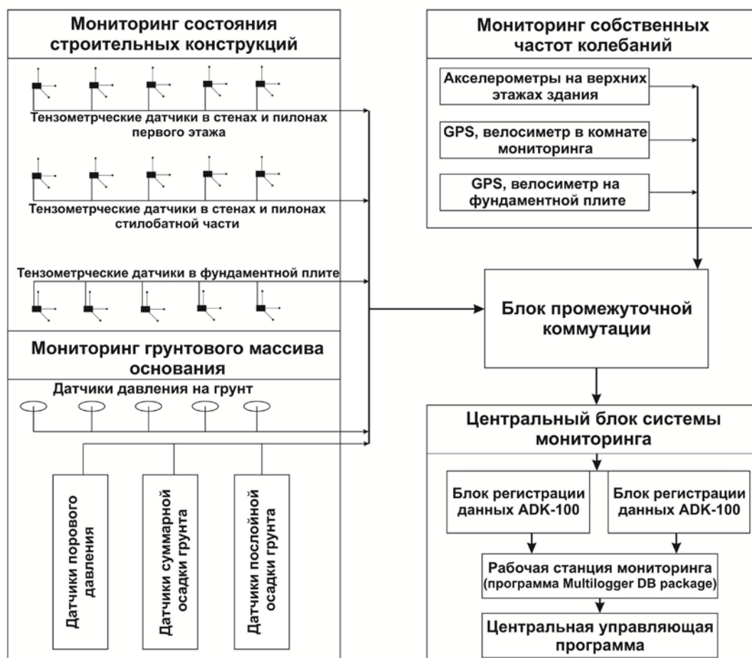
Рис. 5. Блок-схема системы инструментального мониторинга 49-эт. корпуса «Континенталь»
